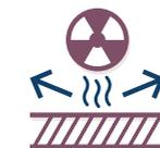
Assurer l'étanchéité de l'interface entre le bâtiment et le sol vis-à-vis du passage du radon (fissures, joints sol/mur, réseaux)
